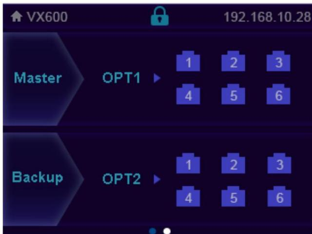
• MasterPort: Zeigt den Verbindungs- und Sicherungsstatus der Ethernet-Ports des VX600 an.
