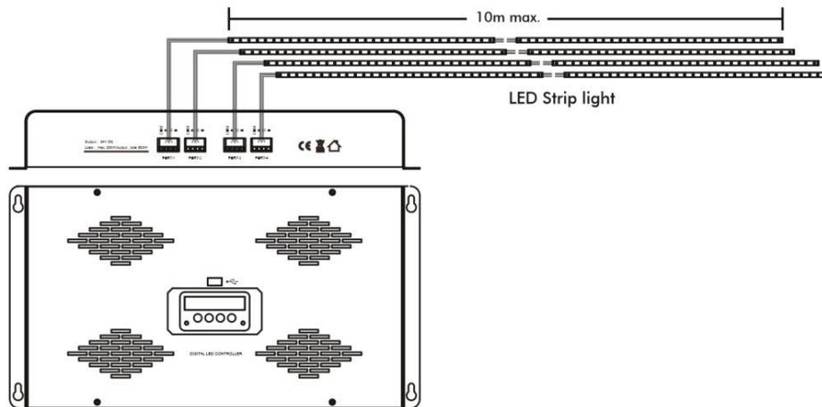
Schließen Sie die Drähte des LED-Streifens korrekt an den Abschlusswiderstand des Farbbandtreibers an, basierend auf dem Farbcode des Drahtes.
