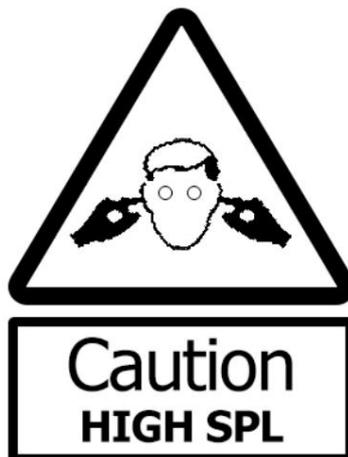
Die Systeme der NEXT-proaudio LA-Serie können extrem hohe Schalldruckpegel erzeugen und sollten mit Vorsicht verwendet werden. Hörverlust ist kumulativ und kann aus Pegeln über 90 dB resultieren, wenn Menschen über einen längeren Zeitraum der Strahlung ausgesetzt sind. Halten Sie sich niemals in der Nähe von Lautsprechern auf, die mit hohen Lautstärken betrieben werden.
