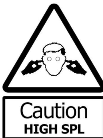
Die Systeme der NEXT-proaudio X-Serie sind in der Lage, extrem hohe Schalldruckpegel zu erzeugen und sollten mit Vorsicht verwendet werden. Hörverlust ist kumulativ und kann aus Pegeln über 90 dB resultieren, wenn Menschen über einen längeren Zeitraum der Strahlung ausgesetzt sind. Halten Sie sich niemals in der Nähe von Lautsprechern auf, die mit hohen Lautstärken betrieben werden.
