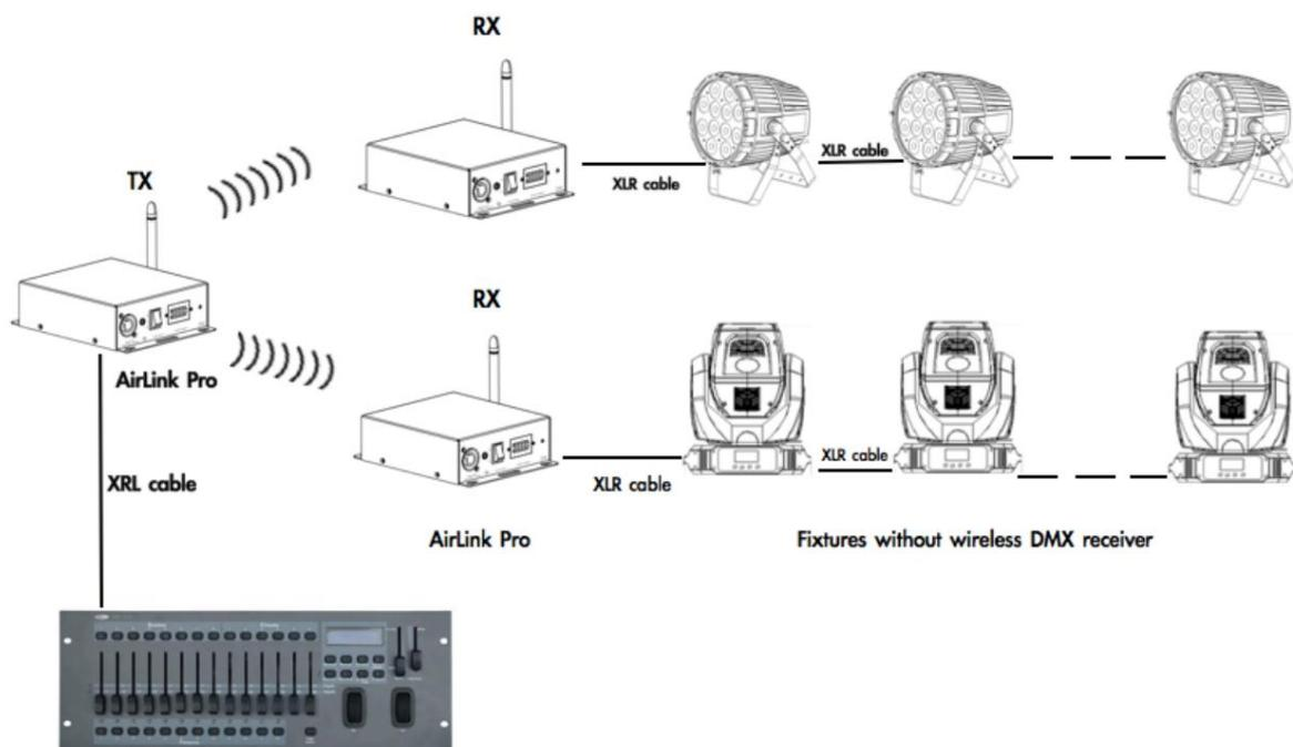
Drücken Sie die „Pairing“-Taste an der Senderbox. Die gelbe Anzeige an der Sender- und Empfängerbox beginnt gleichzeitig zu blinken. Nach einigen Sekunden bleibt die drahtlose DMX-Anzeige eingeschaltet, was bedeutet, dass die Kopplung erfolgreich war. Jetzt können Sie Ihre Leuchten mit Ihrem Lichtpult steuern.
