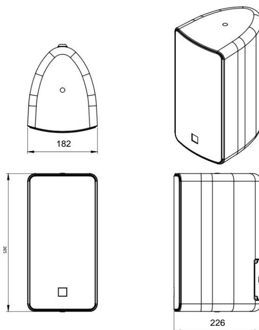
Abmessungen sind in Millimetern angegeben
