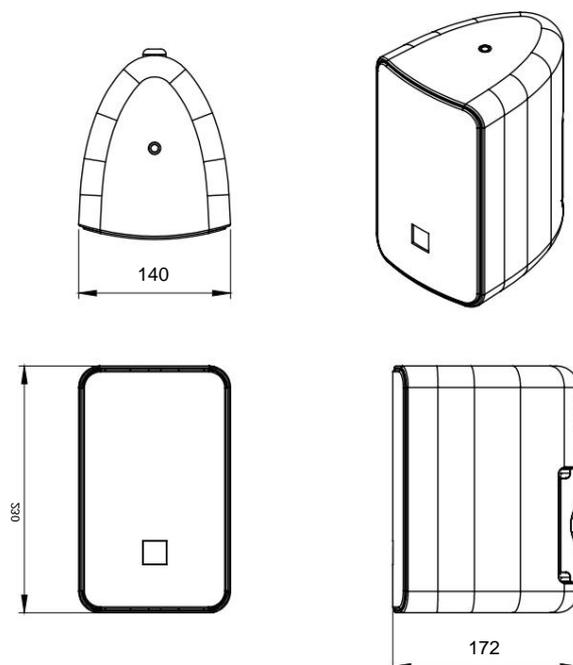
Abmessungen sind in Millimetern angegeben
