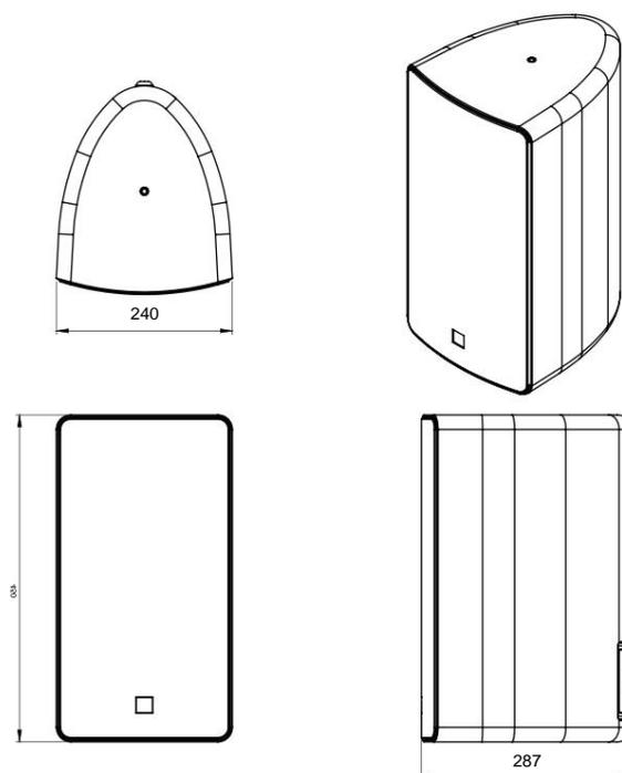
Abmessungen sind in Millimetern angegeben
